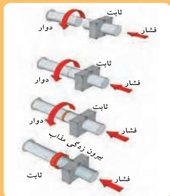
مراحل اجرای فرآیند جوشکاری اصطکاکی
