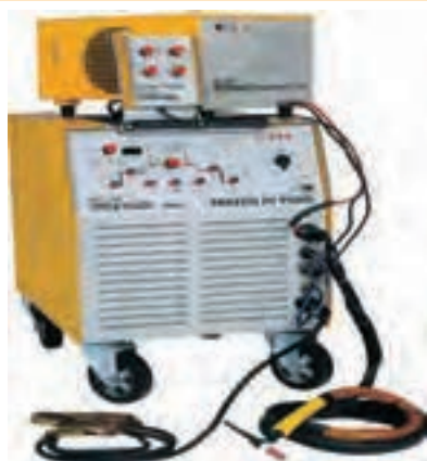
دستگاه فرآیند جوشکاری قوسی با الکتروود تنگستنی تحت پوششی گاز خنثی
