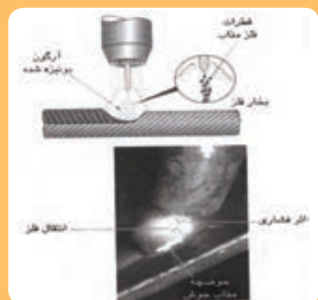
انتقال ذرات مذاب از نوک الکتروود مصرفی به طرف حوضچه مذاب به صورت اسپری
