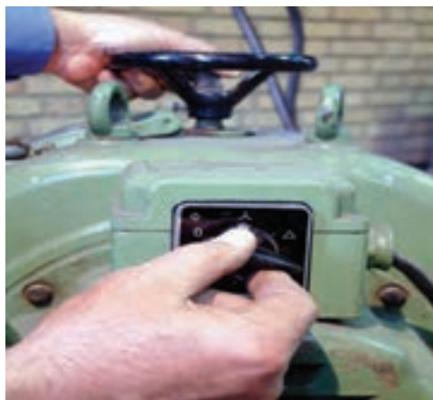
دینام جوش کارگاهی و کلیدهای مخصوص روشن و خاموش کردن دستگاه
