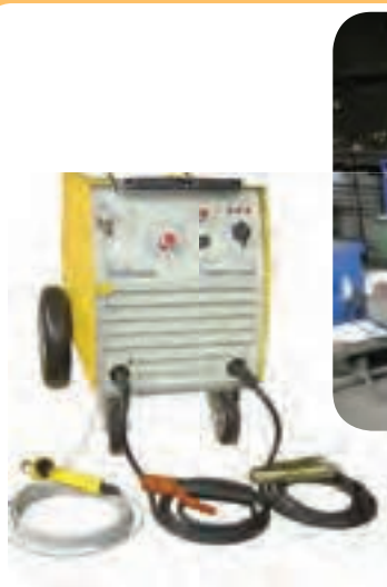
ج) دستگاه‌های جوشکاری نظیر: رکتیفایر، ترانس، دینام و موتور جوش ادامه- برخی از دستگاه‌های موجود در کارگاه‌های جوشکاری
