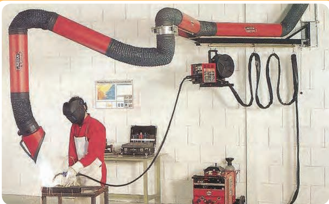
سیستم تهویه قابل انعطاف، دوده‌های متصاعد شده را مکش کرده و مانع از رسیدن آن به صورت جوشکار می‌شود.
