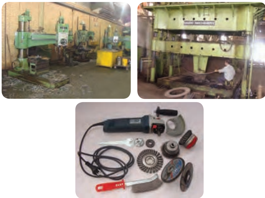
ب) دستگاه‌های آماده سازی و ماشین کاری نظیر: تراش، فرز، دریل، سنگ‌زنی، پرس کاری و پخ کاری
