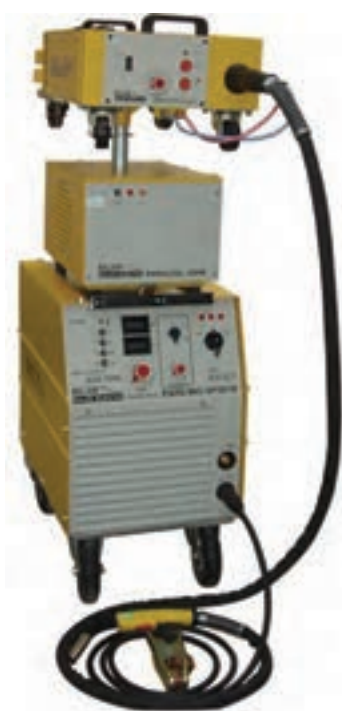
دستگاه فرآیند جوشکاری قوسی با الکتروود فلزی تحت پوشش گاز محافظ
