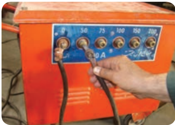
تنظیم آمپر در دستگاه ترانسفورماتور پله‌ای
