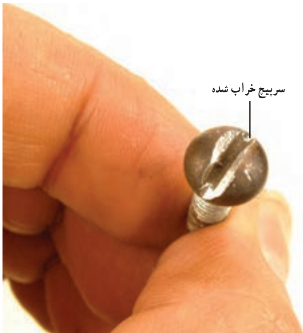
شکل ۹-۱- اثرات استفاده نامناسب از ابزار
