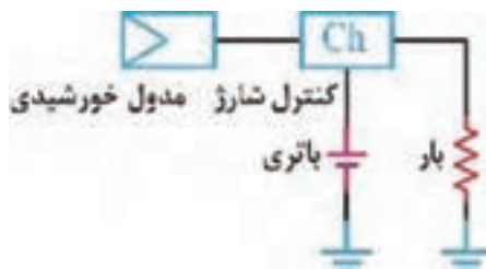
شکل ۹- شمای فنی سامانه فتوولتائیک
