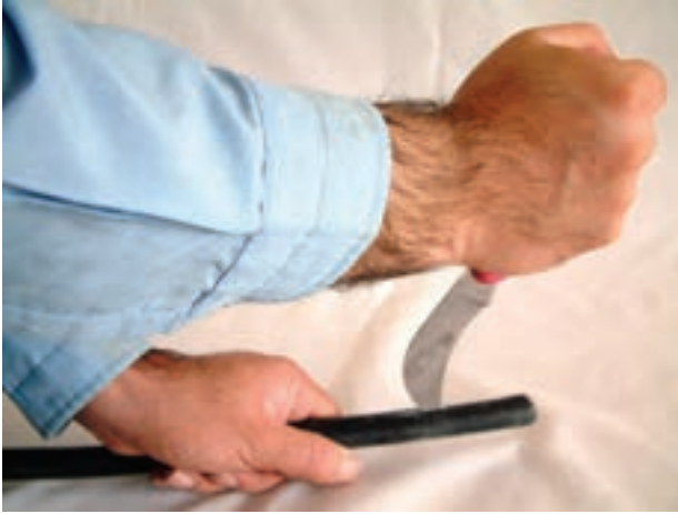
شکل ۳۳-۵- طریقه‌ی صحیح روکش برداری کابل
