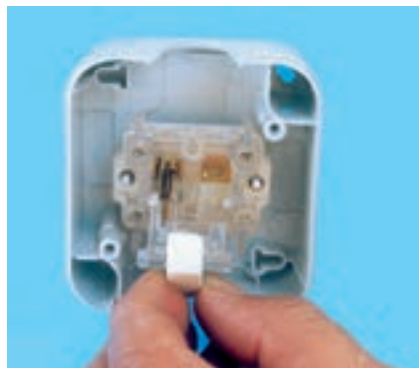
ب - شستی و فنر کلید تبدیل
