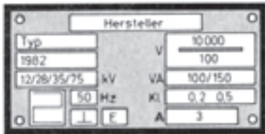
شکل ۵-۶۹- پلاک مشخصات ترانسفورماتور ولتاژ
