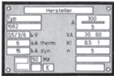
شکل ۵-۶۷- تابلوی مشخصات ترانسفورماتور جریان
