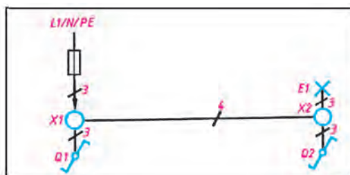
شکل ۱۷- شمای فنی کلید تبدیل
