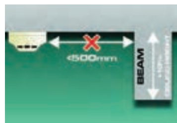
شکل ۸۷- محل نصب دتکتور از سقف و هر مانع دیگر
