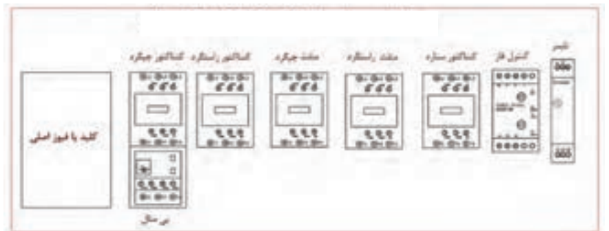
شکل ۱۱۸- چیدمان عمومی مدار ستاره - مثلث چپ گرد - راست گرد قدرت مستقل
