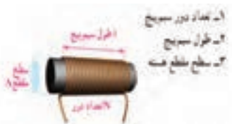
شکل ۸-۳- پارامترهای مهم در یک سلف
