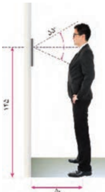
شکل ۹۸- ارتفاع نصب پنل دم در ورودی ساختمان (بر حسب سانتی متر)
