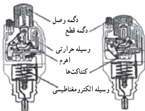
شکل ۱-۶ - ساختمان داخلی فیوز آلفا
