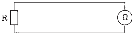
شکل ۵-۵۴- مدار اتصال اهم متر به مقاومت
