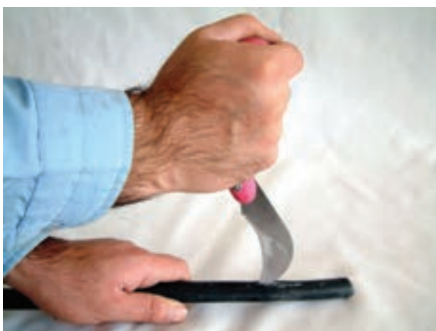
شکل ۳۲-۵ - روکش برداری غلط
