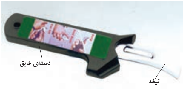
شکل ۱۴-۱- چاقوی کابل‌بری با دسته‌ی حفاظدار
