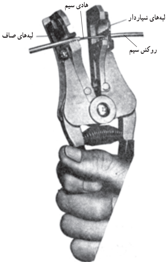
شکل ۹-۱- سیم لخت‌کن خودکار در حال روکش برداری
