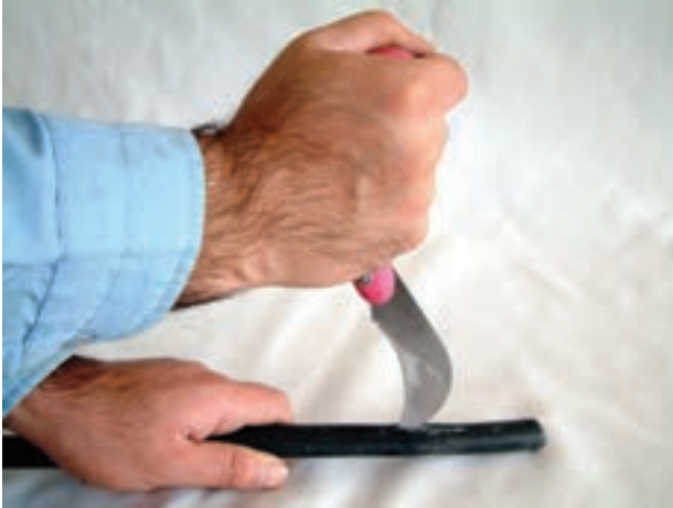
الف - نحوه‌ی غلط لخت کردن کابل
