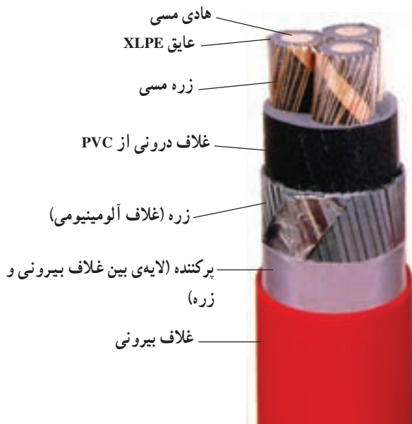
شکل ۵-۷- کابل با غلاف آلومینیومی
