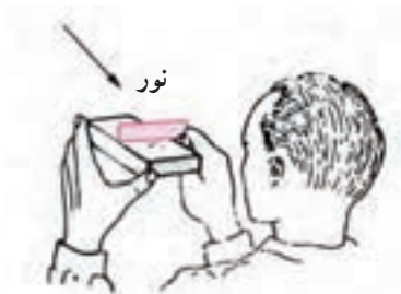
شکل ۱-۲۳- کنترل زاویه قائمه با گونیا
