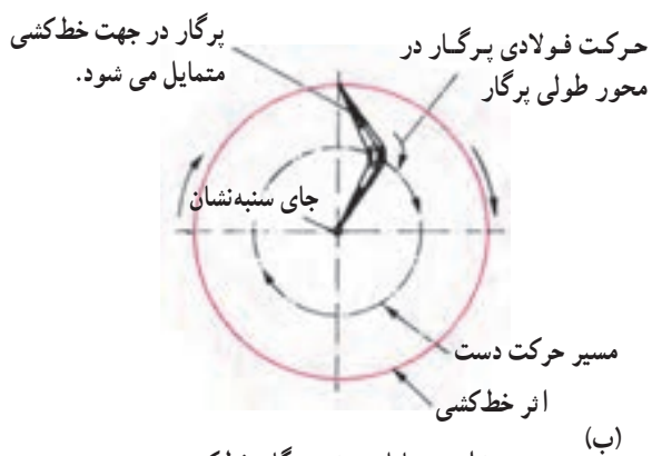
زاویه تمایل سوزن پرگار خط‌کشی
