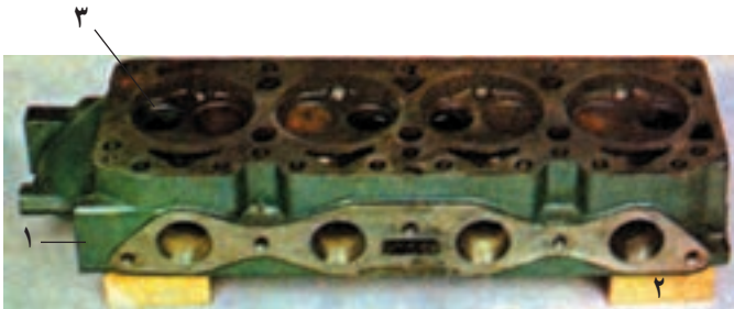
۱- سرسیلندر ۲- قطعه چوب ۳- نشیمنگاه شکل ۱۵-۸
