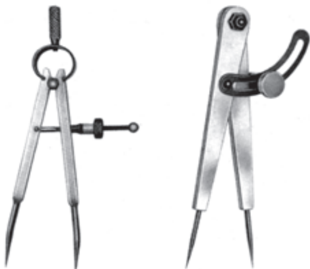
ب - پرگار فنی با پیچ تنظیم
