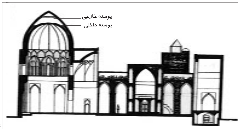
تصویر ۵-۲۰- سقف دو پوسته در گنبد
