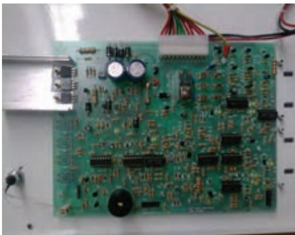
شکل ۱-۲۹ مدار الکترونیکی یک نمونه تابلو اعلام حریق
