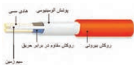
شکل ۱-۲۴ قسمت‌های مختلف یک کابل اعلام حریق
