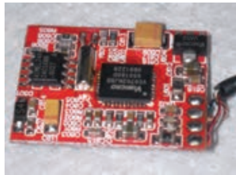
شکل ۳-۲۵ مدار الکترونیکی دوربین
