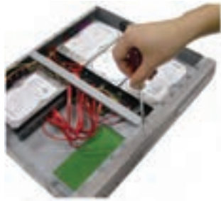
شکل ۳-۶۸ دیسک سخت نصب شده در داخل دستگاه
