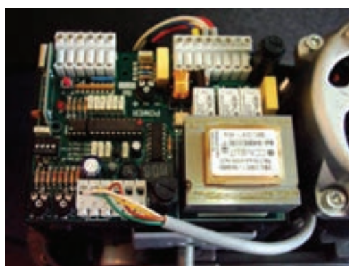
شکل ۱۸-۴ برد الکترونیکی در اتوماتیک ریلی
