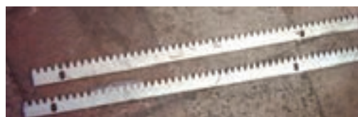
شکل ۴-۳۲ دنده های شانه ای
