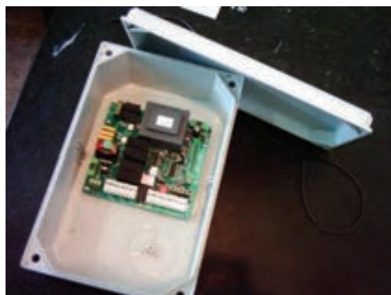
شکل ۱۷-۴ برد الکترونیکی در اتوماتیک لولایی
