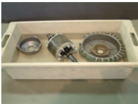
شکل ۱-۳۲ - شست‌وشوی قطعات با آب گرم
