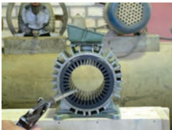
شکل ۱-۳۱ - بادگیری قطعات جدا شده
