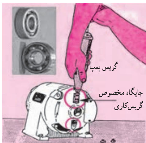
شکل ۱-۳۳ - گریس کاری بلبرینگ‌ها
