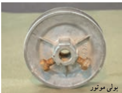
شکل ۱-۲۵- باز کردن پولی موتور
