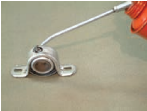
شکل ۱-۳۴- روغن کاری یاتاقان ها
