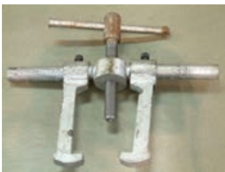
شکل ۴۸-۱ ابزار درآوردن بوش و یاتاقان‌های استوانه‌ای
