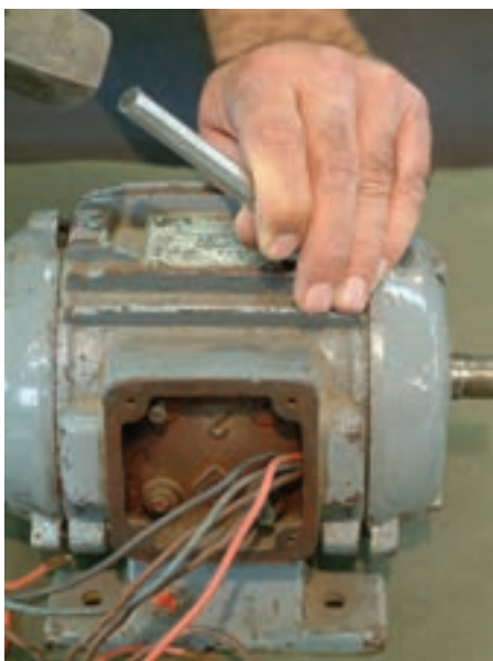
شکل ۱-۲۶- باز کردن درپوش موتور
