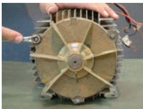
شکل ۱-۲۴- پیچ و مهره‌های باز شده از موتور
