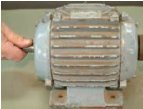
شکل ۴۵-۱ بررسی لقی بوش‌ها
