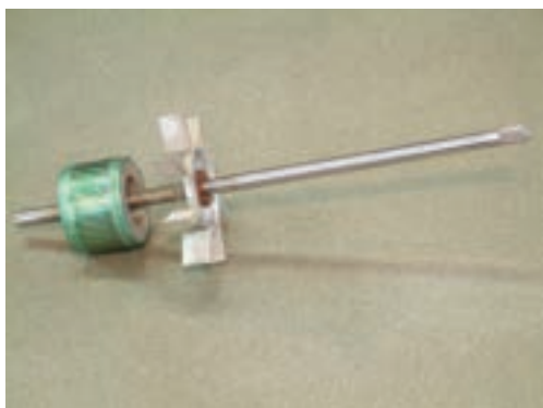
شکل ۱-۲۸- پروانه‌ی نصب شده روی محور روتور
