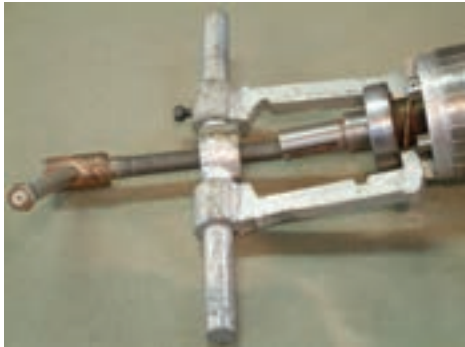
شکل ۴۶-۱ استقرار بلبرینگ کش روی محور روتور
