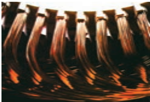
شکل ۲-۳۰- عایق‌گذاری بین طبقات
