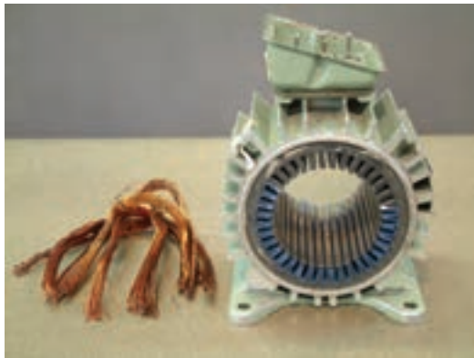
شکل ۲۴-۲- سیم‌های بیرون آمده از استاتور
