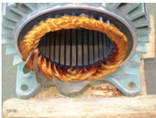
شکل ۲-۳۱- عایق‌کاری پیشانی کلاف‌ها
