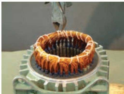
شکل ۲-۱۳ - چیدن نخ‌های کلاف‌بندی با سیم‌چین
