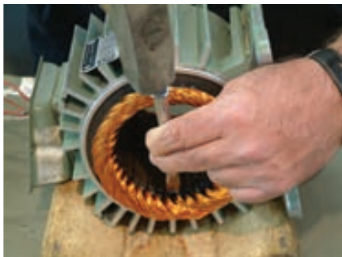
ب - ضربه زدن به قلم شکل ۲-۲۰ - بریدن سیم ها به وسیله قلم
