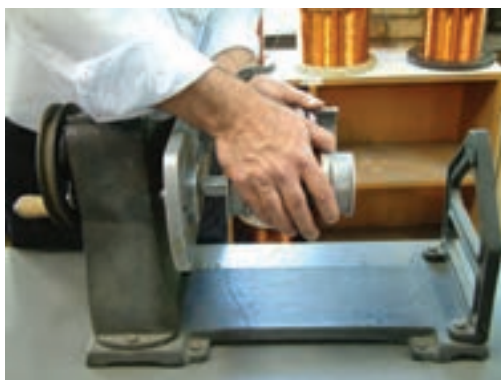
شکل ۱۸-۳ - باز کردن قالب‌ها
