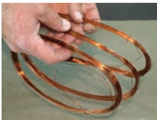
شکل ۱۹-۳ - درآوردن کلاف از قالب
