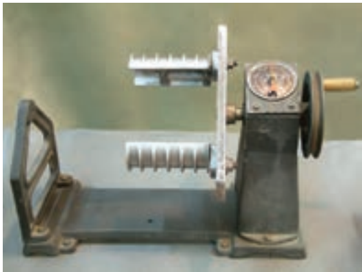
شکل ۱۵-۳- تنظیم اندازه‌ی قالب‌ها در کلاف پیچ
