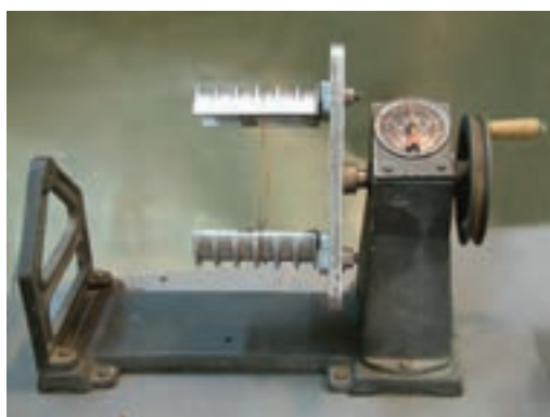
شکل ۳-۵- تنظیم قالب‌ها بر اساس اندازه‌ی کلاف
