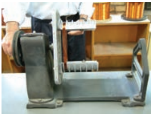
شکل ۱۷-۳ - بیچیدن سیم‌ها روی قالب‌ها
