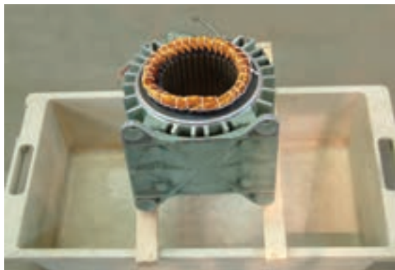
شکل ۴-۲۲- خارج کردن اضافات شارلاک از استاتور
