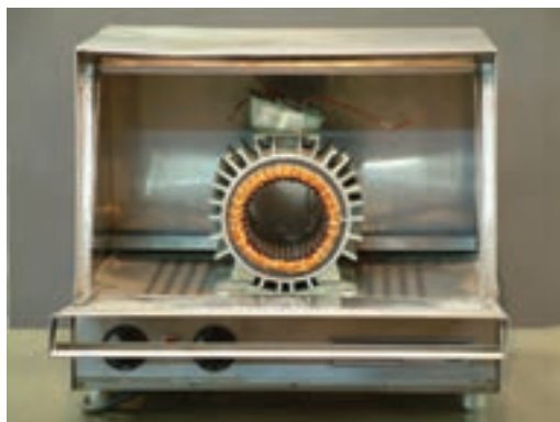
شکل ۲۰-۴- گرم کردن استاتور
