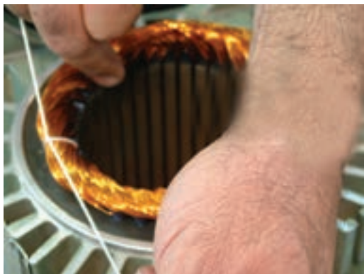
شکل ۴-۱۴- گره زدن یک سر نخ
