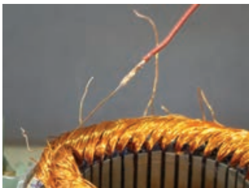
شکل ۴-۱۱- اتصال سیم‌های افشان به سیم‌های لاک‌ی
