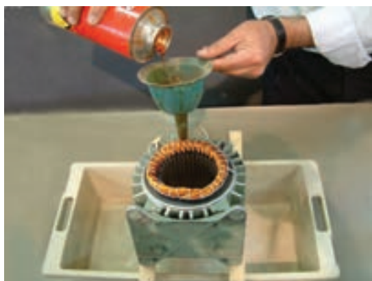
شکل ۴-۲۵ – ریختن شارلاک روی سیم ها
