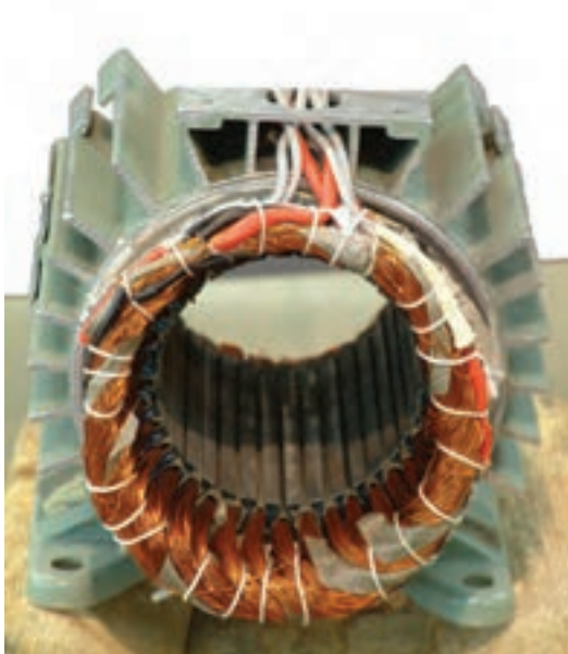
شکل ۴-۱۷- نمایش استاتور نخ‌بندی شده از دو سمت
