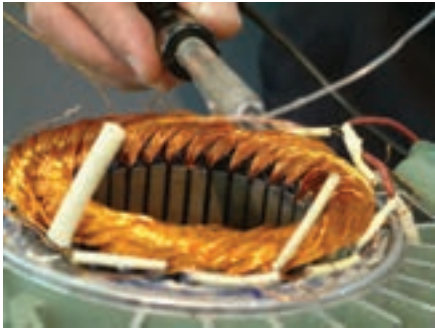
شکل ۴-۷- لحیم کاری محل اتصال سیم ها
