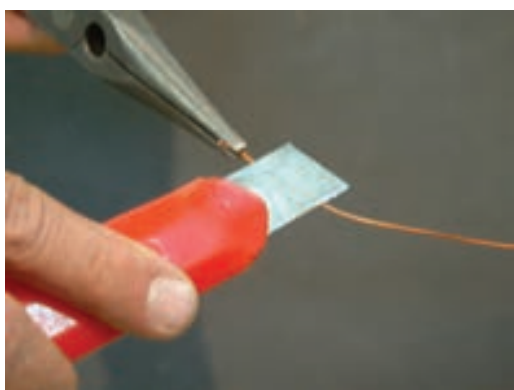
شکل ۴-۱ ج - پاک کردن لاک به روش تراشیدن
