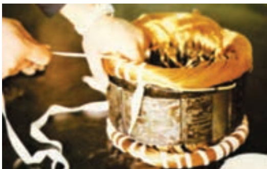
شکل ۴-۱۸- نواربندی سیم‌های استاتور
