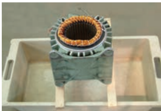
شکل ۴-۲۴ – قرار دادن استاتور روی وان
