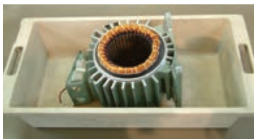
شکل ۲۱-۴- قرار دادن استاتور در درون وان شارلاک
