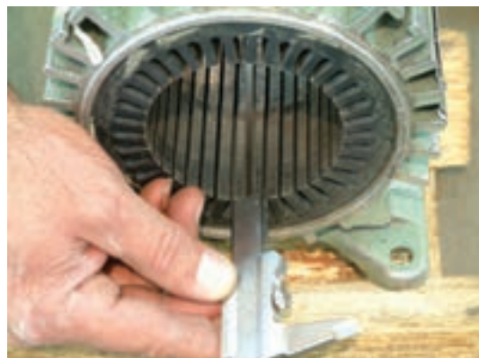
شکل ۲۶-۲- اندازه گیری محیط داخلی و طول شیار
