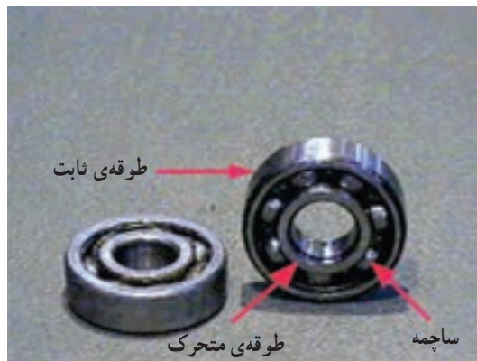
شکل ۱-۳۶- ساختمان بلبرینگ
