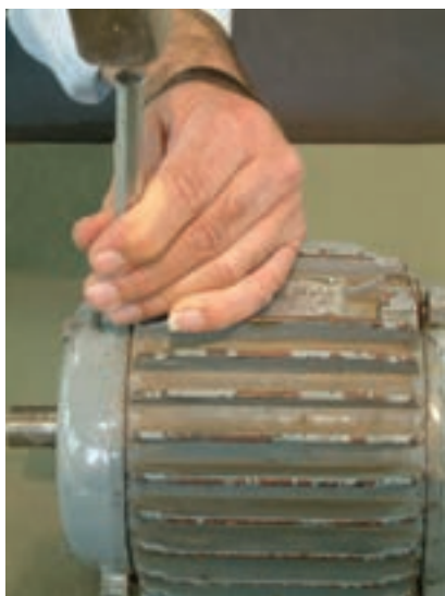
شکل ۱-۲۳- علامت‌گذاری روی پوسته و درپوش‌ها
