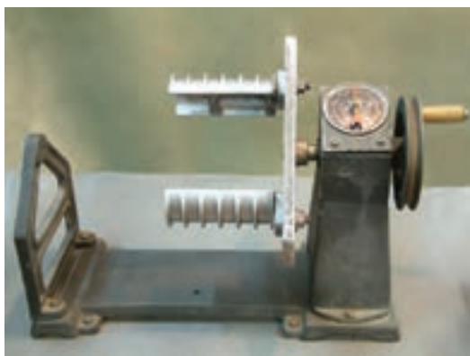
شکل ۱۵-۳- تنظیم اندازه‌ی قالب‌ها در کلاف پیچ
