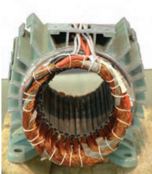
شکل ۴-۱۷– نمایش استاتور نخ‌بندی شده از دو سمت
