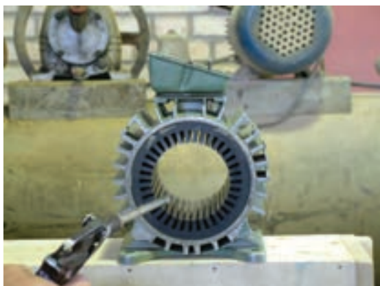
شکل ۱-۳۱ - بادگیری قطعات جدا شده
