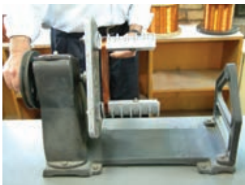
شکل ۱۷-۳ پیچیدن سیم‌ها روی قالب‌ها
