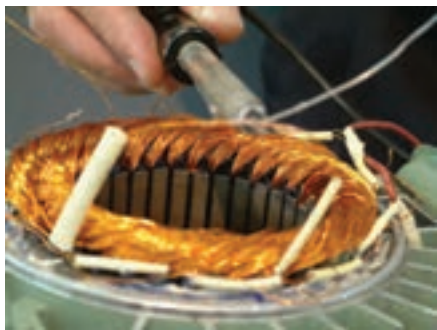
شکل ۴-۷ - لحیم کاری محل اتصال سیم ها
