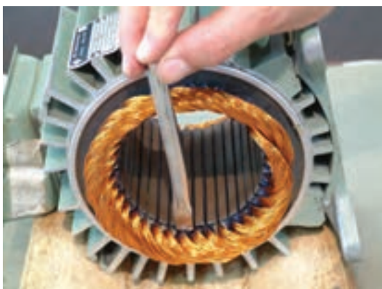
الف- قرار دادن قلم روی سیم‌ها
