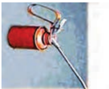
شکل ۱-۳۴- روغن کاری یاتاقان ها
