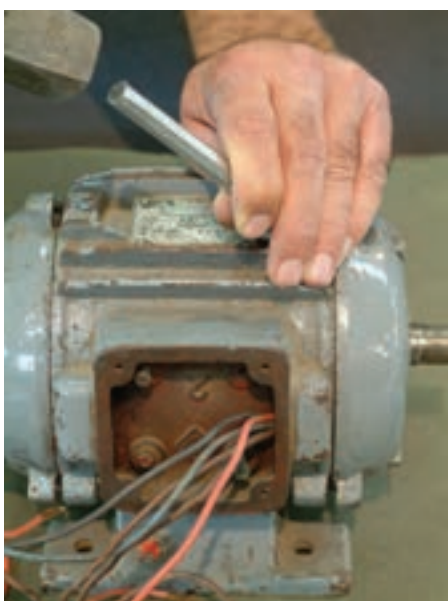
شکل ۱-۲۶ باز کردن درپوش موتور
