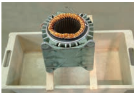
شکل ۴-۲۴- قرار دادن استاتور روی وان
