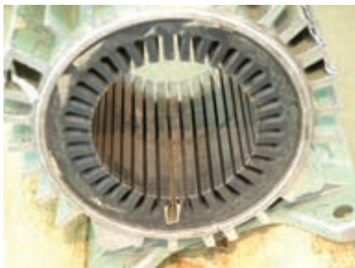
شکل ۲-۳۶- آزمایش عایق در داخل شیار
