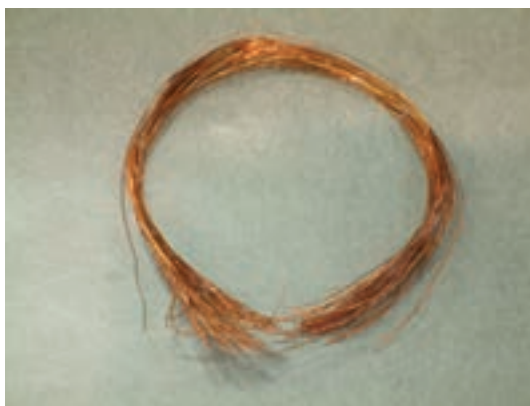
شکل ۱۶-۳- الف - شمارش تعداد دور هر بوبین
