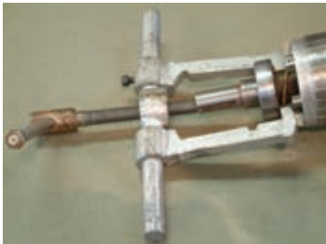
شکل ۴۶-۱- استقرار بلبرینگ کشر روی محور روتور
