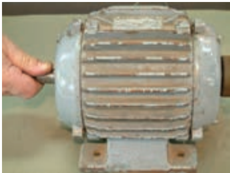
شکل ۴۵-۱- بررسی لقی بوش‌ها
