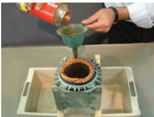
شکل ۴-۲۵- ریختن شارلاک روی سیم ها
