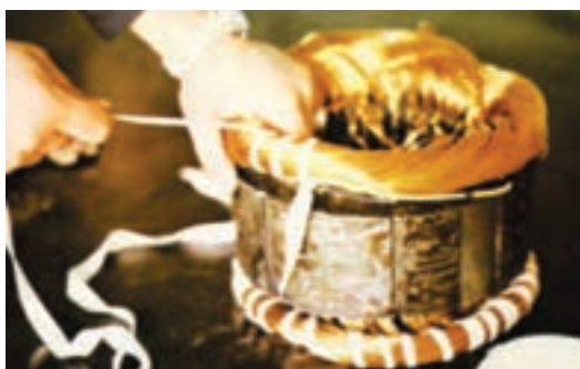
شکل ۴-۱۸– نواربندی سیم‌های استاتور
