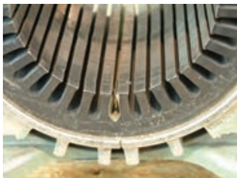
شکل ۲-۳۳- اندازه گیری محیط شیار
