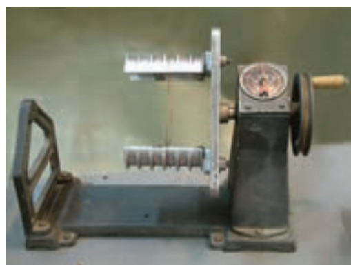
شکل ۳-۵- تنظیم قالب‌ها براساس اندازه‌ی کلاف
