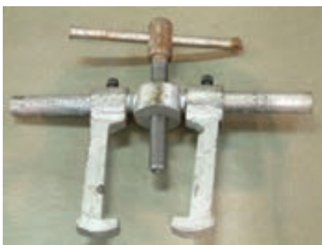
شکل ۴۸-۱- ابزار درآوردن بوش و یاتاقان‌های استوانه‌ای
