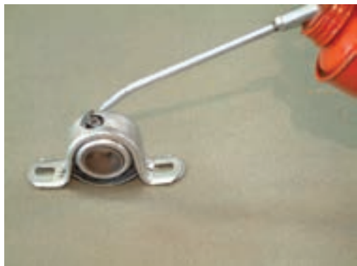
شکل ۱-۳۴- روغن کاری یاتاقان ها
