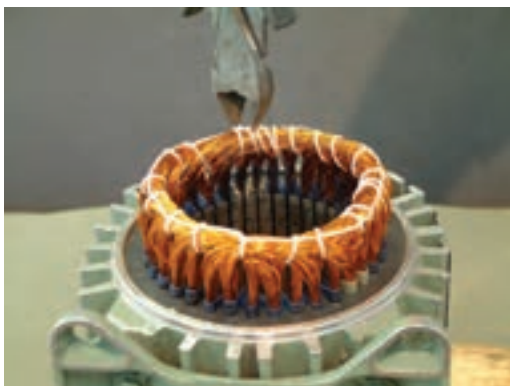
شکل ۲-۱۳ – چیدن نخ‌های کلاف‌بندی با سیم‌چین
