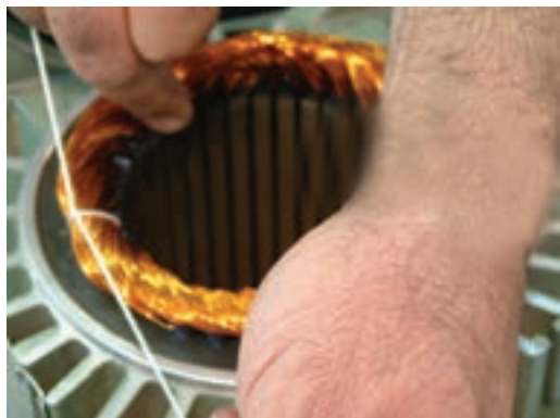
شکل ۴-۱۴- گره زدن یک سر نخ
