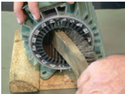
ب – تمیز کردن استاتور با برس سیمی
