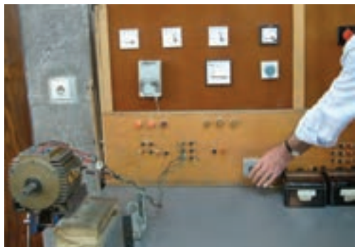
شکل ۶-۹- اتصال موتور به تابلوی برق
