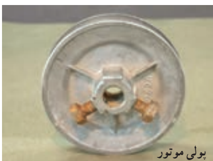
شکل ۱-۲۵ باز کردن پولی موتور
