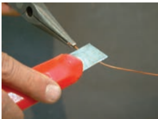
شکل ۴-۱ ج - پاک کردن لاک به روش تراشیدن
