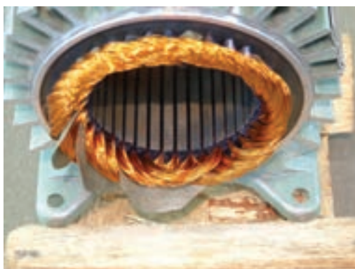
شکل ۲-۳۱- عایق کاری پیشانی کلاف‌ها
