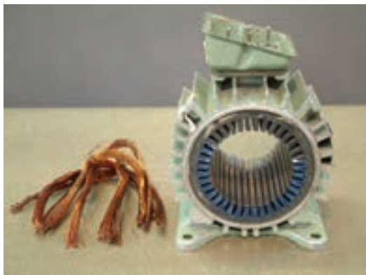
شکل ۲-۲۴ - سیم‌های بیرون آمده از استاتور
