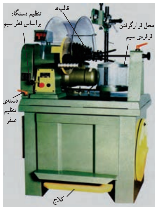
شکل ۱۳-۳- ماشین کلاف پیچ
