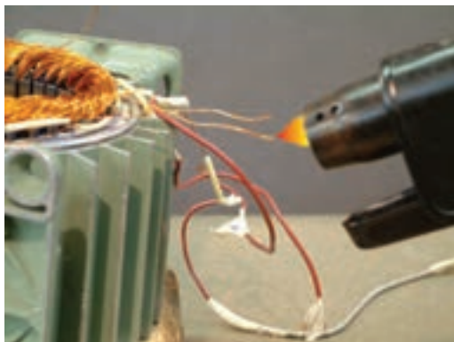
شکل ۴-۱ ب - پاک کردن لاک به روش سوزاندن
