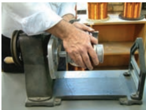
شکل ۱۸-۳ باز کردن قالب‌ها
