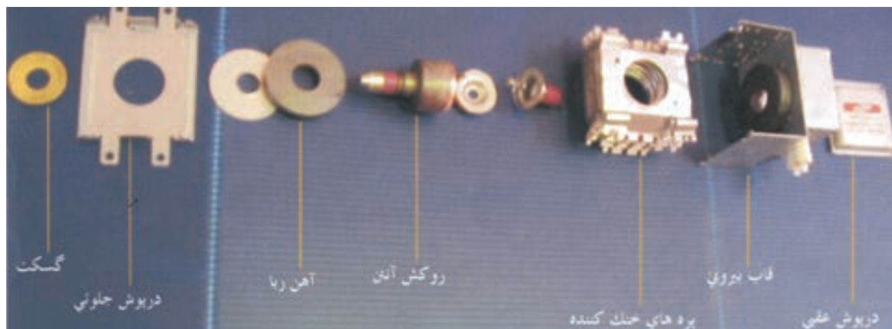
شکل ۳-۹۶ نقشه ی انفجاری قطعات یک مگنترون
