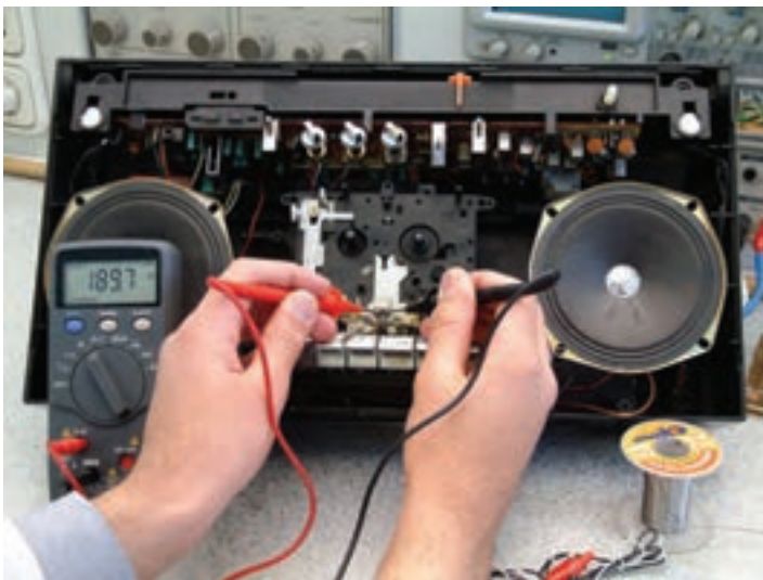
شکل ۱-۴۹- اندازه‌گیری مقاومت هد برای تعیین قطع‌شدگی، اتصال کوتاه و یا اتصال به نقطه‌ی زمین
