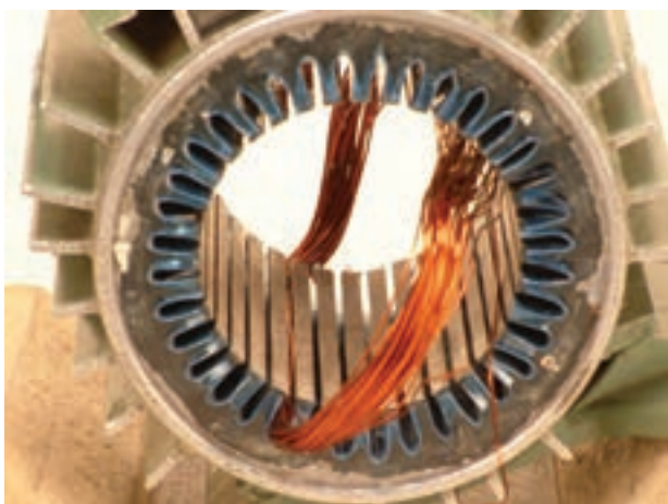
شکل ۲-۷- قرارگرفتن یک بازو در داخل یک شیار
