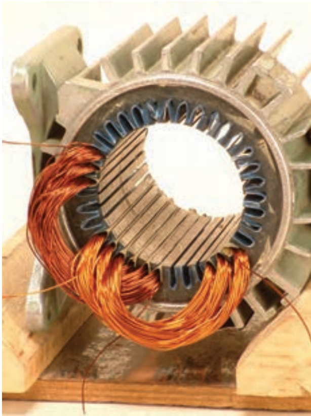
شکل ۲-۲۲- شروع گروه کلاف سوم از شیار شماره ۱۳
