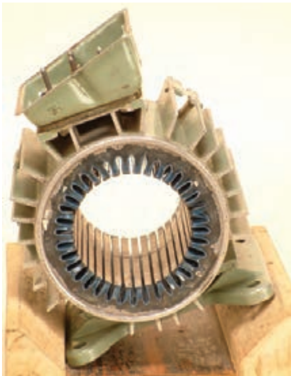
شکل ۱۳-۲- انتخاب شیار شروع و مسیر کلاف‌گذاری
