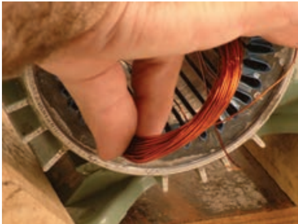
شکل ۱۵-۲- قراردادن بازوی شماره یک در شیار شماره ۱
