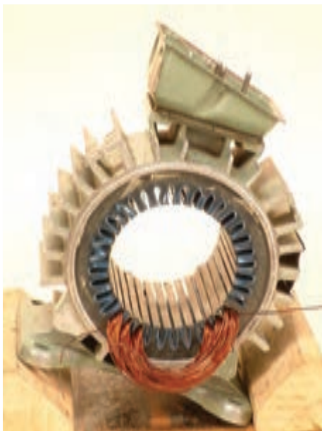
شکل ۲-۱۸- قرار گرفتن گروه کلاف شماره یک در داخل شیارها
