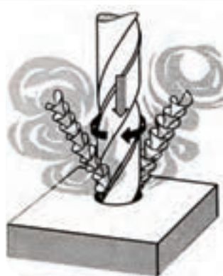
سوراخ کاری از طریق برداری با حرکت همزمان دورانی و خطی
