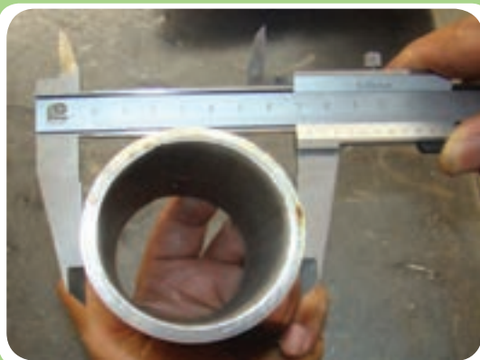
اندازه گیری قطر خارجی لوله توسط کولیس
