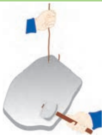
آزمایش ضربه یکی از روش‌های شناخت کارگاهی فلزات است
