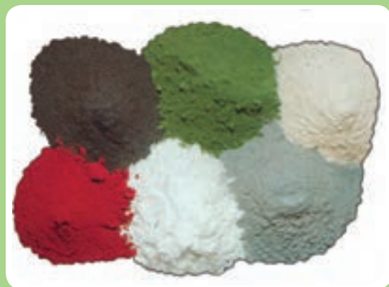
مواد پودری تشکیل دهنده روپوش الکتروود
