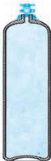
کپسول فولادی مخصوص برای ذخیره اکسیژن
