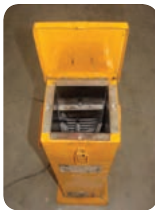
آون جهت خشک کردن رطوبت موجود در روپوش الکترودها
