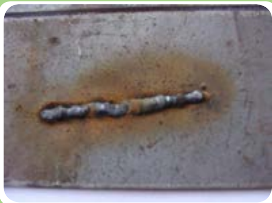
جوشکاری با الکتروده بدون روپوش یا صدمه دیده سبب ایجاد مقدار زیادی جرقه و پاشش فلز مذاب می‌گردد.
