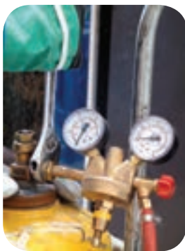
محکم کردن اتصالات رگولاتور به کپسول گاز
