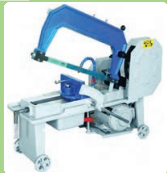
دستگاه اره لنگ که برای بریدن قطعات فلزی استفاده می‌شود
