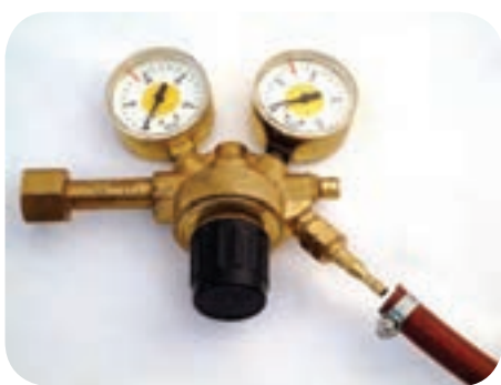
اتصال شیلنگ به رگولاتور گاز
