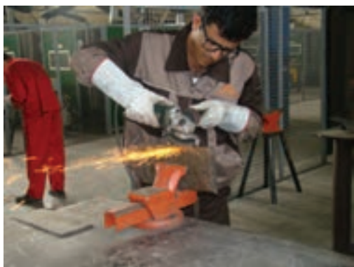
تشخیص نوع فولاد بر اساس آزمایش جرقه
