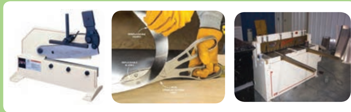
ابزار برشکاری که بدون بهره برداری عمل برش را انجام می دهند
