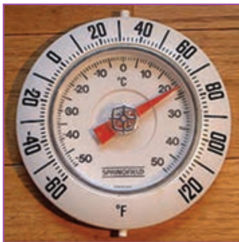
شکل ۳-۵ دماسنج با دو مقیاس
