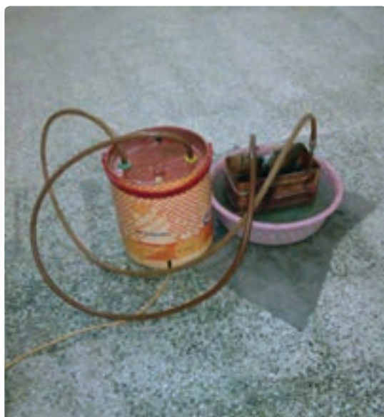
شکل ۲۰-۵- رسوب زدایی مبدل آب گرم کن با دستگاه ویژه
