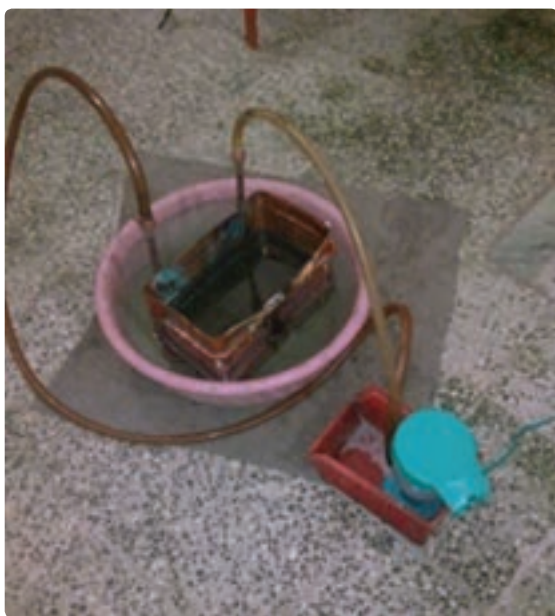
شکل ۱۹-۵- رسوب‌زدایی با پمپ
