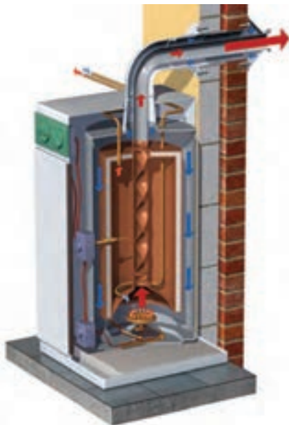
شکل ۳-۱۳- یک مبدل گاز به مایع (آب گرم کن زمینی)
