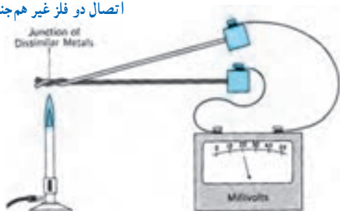
الف) ترموکوپل گرم شده توسط شعله ۲۰ mv برق تولید می‌کند.
