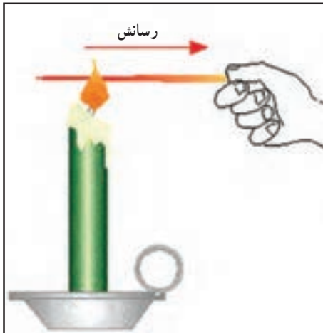
شکل ۳-۸- رسانش در یک میله فلزی
