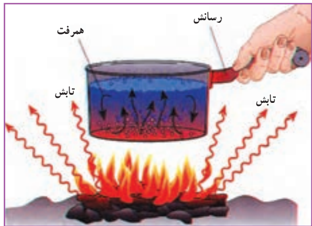
شکل ۳-۱۱- انتقال گرما به هر سه روش
