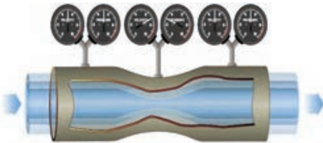
شکل ۳-۳۳- تغییرات فشار و سرعت در یک شیپوره
