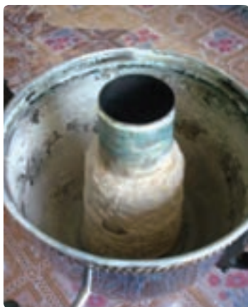
شکل ۸-۵- تشکیل رسوب در سماور و لوله‌ها
