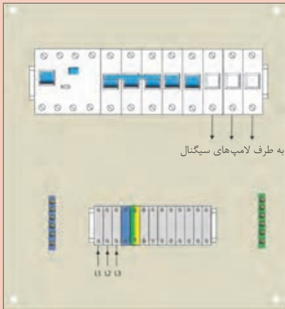
شکل ۳۹- نقشه جانمایی تابلو
