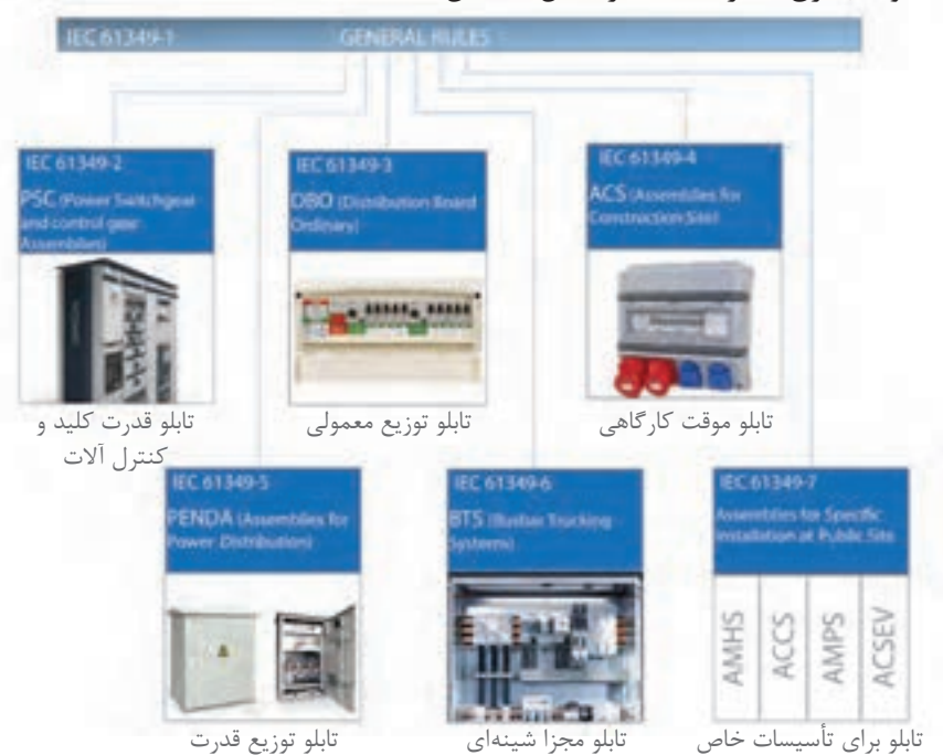
شکل ۳- دسته بندی انواع تابلوهای برق فشار ضعیف
