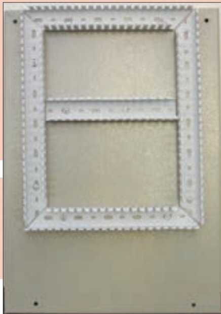
شکل ۸۲ - صفحه نصب آماده برای جانمایی محل ریل‌های فلزی
