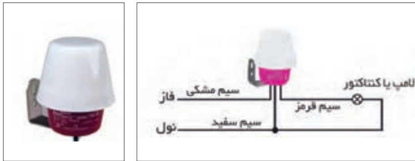
شکل ۹۷- کنترل خودکار روشنایی سنتی
