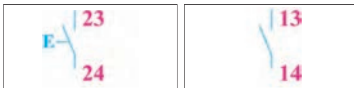
شکل ۶۲- تیغه فرمان با وضعیت باز شکل ۶۳- تیغه فرمان با وضعیت بسته
