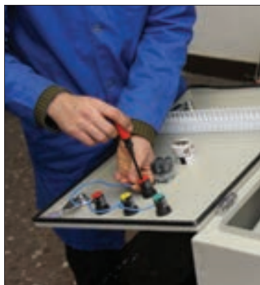
شکل ۹۳- سیم‌کشی چراغ‌های سیگنال
