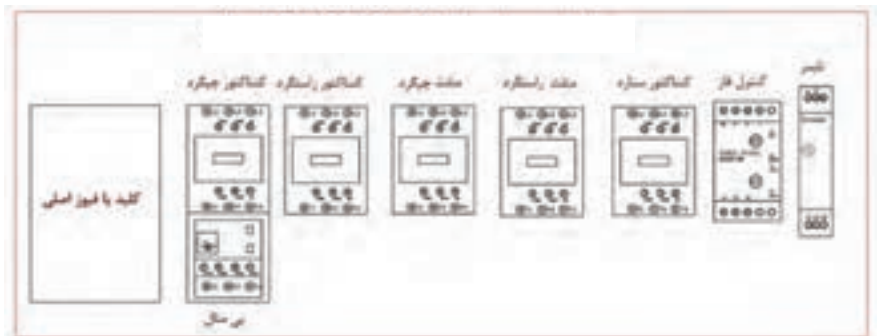
شکل ۱۸- چیدمان عمومی مدار ستاره - مثلث چپگرد - راستگرد قدرت مستقل
