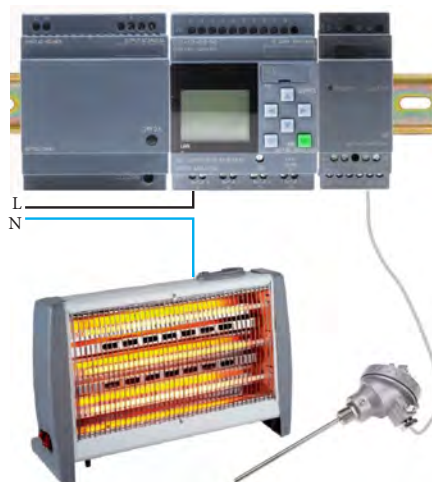
شکل ۴- اندازه‌گیری و کنترل دما با استفاده از رله قابل برنامه‌ریزی
