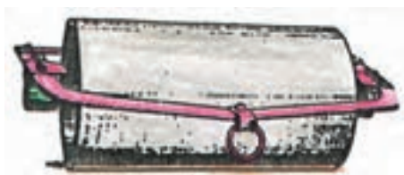
شکل ۵-۳- غلتک معمولی صاف
