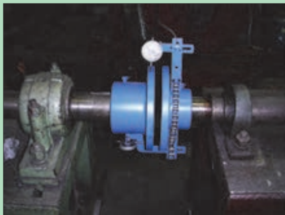
شکل ۷۷- هم‌راستا کردن محورها با ساعت اندازه‌گیری
