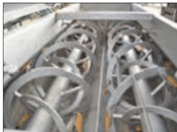
شکل ۸- مخلوط‌کن افقی و مارپیچ‌های آن
