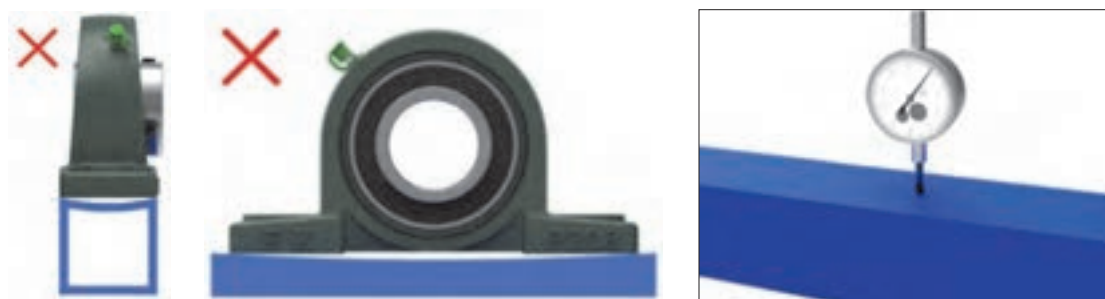
شکل ۶۳- کنترل محل نصب محفظه بلبرینگ
