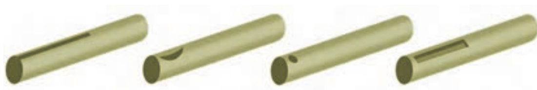
شکل ۸۰-انواع جای خار روی محورها
