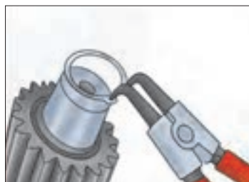
شکل ۸۳-در آوردن خار حلقوی با استفاده از خار بازکن
