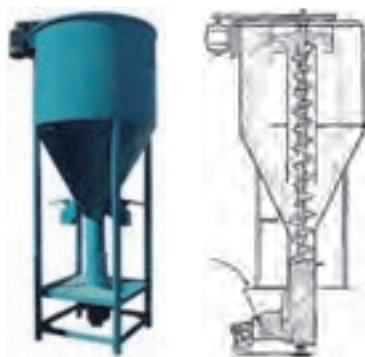
شکل ۷- مخلوط‌کن عمودی و نحوه عملکرد آن
