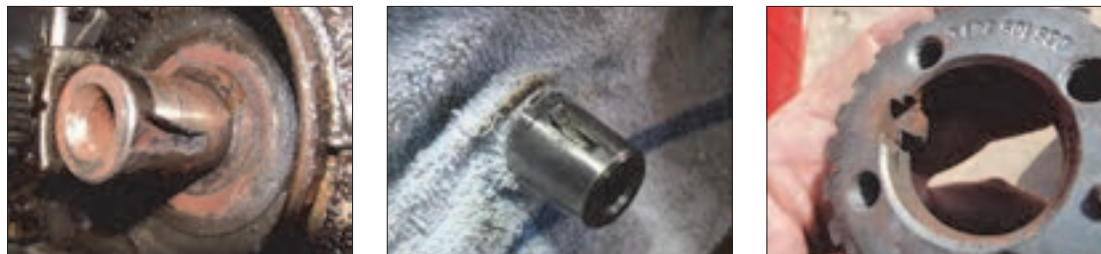
شکل ۸۱-نمونه ای از معایب مربوط به خارها
