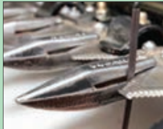
شکل ۶۴- تأثیر زیاد بودن فاصله لب انگشتی
