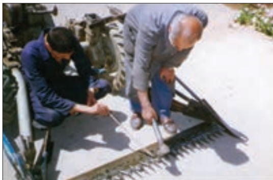
شکل ۶۲- استفاده از چکش یک کیلویی جهت تنظیم گیره
