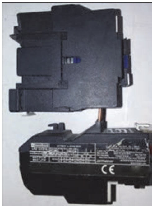
ج) اتصال بی‌متال زیر کنتاکتور
