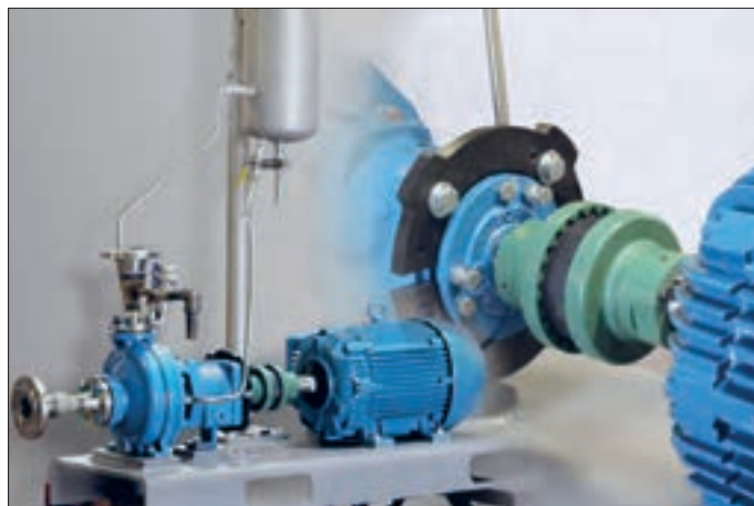
شکل ۸- انتقال قدرت مستقیم از موتور به دستگاه
