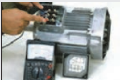
شکل ۶- آزمایش الکتروموتور با استفاده از مولتی متر
