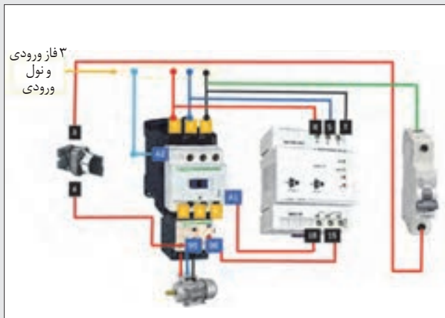
شکل ۳۳- مدار راه اندازی موتور سه فاز با حفاظت کامل و با استفاده از کلید ۱-۰
