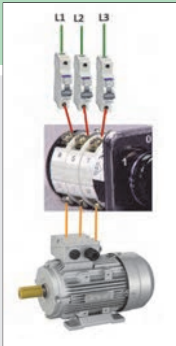
شکل ۲۷- نحوه کابل کشی و برق رسانی به یک موتور سه فاز آسنکرون با کلید زبانهای (۱-۰)
