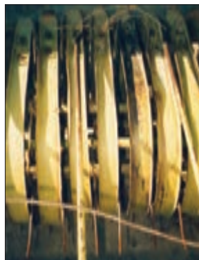
شکل ۲۲- تسمه ساییده و کج شده
