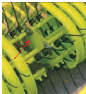
شکل ۱۶- یاتاقان محور انگشتی و محل نصب آن
