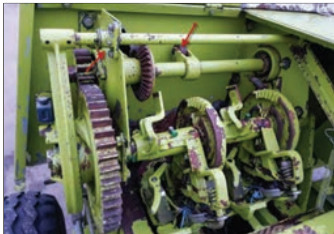
شکل ۷۵- یاتاقان‌ها و نگهدارنده فرمان‌دهنده گره‌زن
