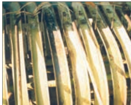
شکل ۶- ساییده شدن انگشتی‌ها به تسمه‌های راهنما
