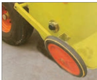
شکل ۲۸- چرخ تنظیم کج شده
