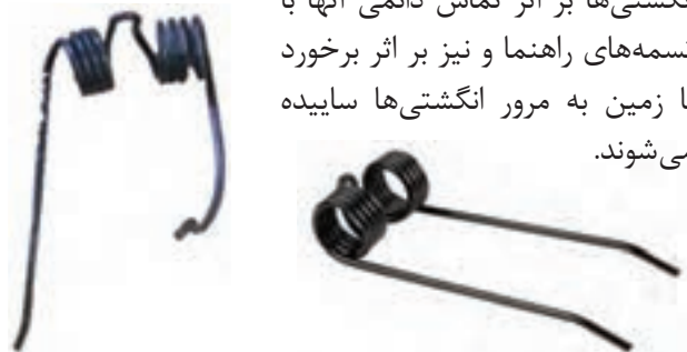
شکل ۴- تفاوت انگشتی سالم و انگشتی معیوب
