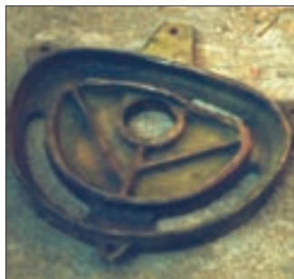
شکل ۱۸- صفحه بادامکی معیوب
