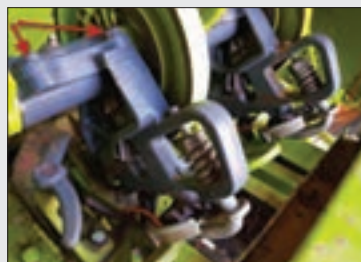
شکل ۴۵- پیچ‌های پوسته گره زن
