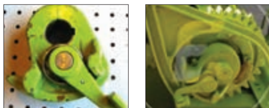
شکل ۷۰- ضامن کلاچ گره‌زن و موقعیت آن روی گره‌زن
