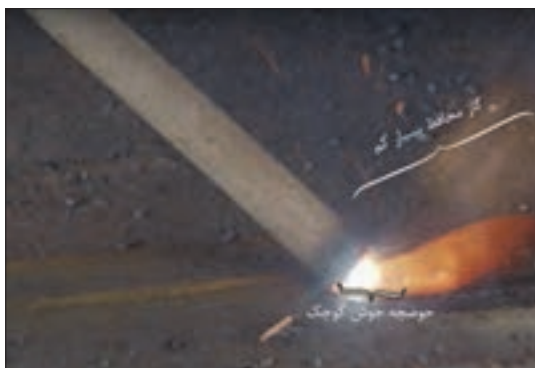
شکل ۲۶- جوشکاری با آمپر بسیار پایین
