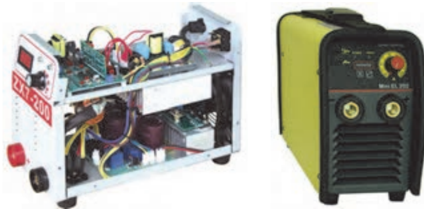
شکل ۱۳- اینورتر جوشکاری و اجزای داخلی آن
