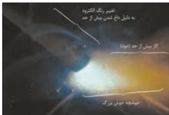
شکل ۲۷- جوشکاری با آمپر بسیار بالا
