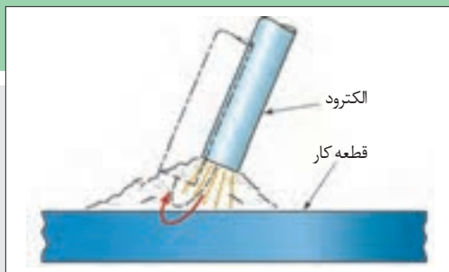
شکل ۲۳- نحوه الکتروود در حین خال جوش زدن
