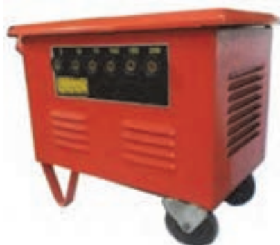
شکل ۸- ترانس با مکانیزم تغییر آمپر پله‌ای
