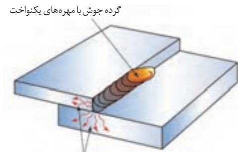
شکل ۴۶- الگوی J شکل اجازه می‌دهد تا گرما روی قطعه ضخیم‌تر متمرکز شود جهت انتقال حرارت از جوش به فلز پایه
