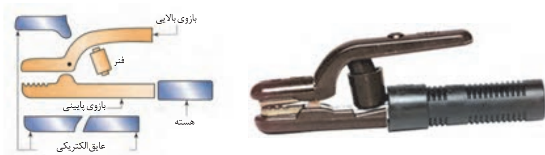
شکل ۱۷- انبر الکتروود و قسمت های قابل تعویض آن
