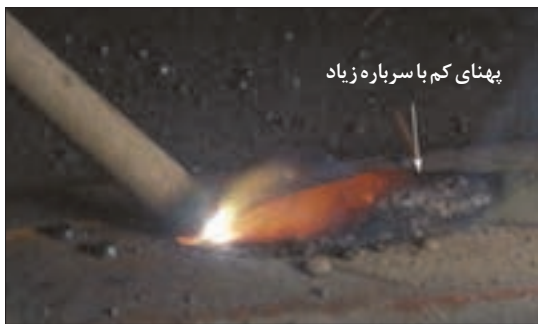
شکل ۳۰- جوشکاری با طول قوس بسیار کم
