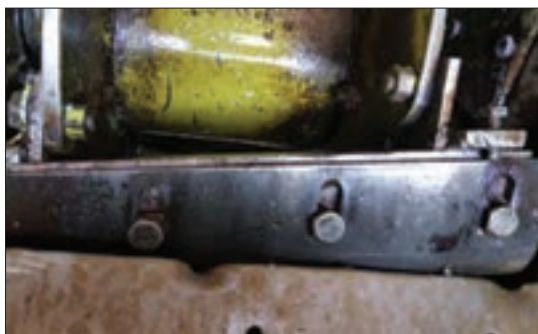
شکل ۴۴- پیچ و شیارهای رگلاژ تیغه متحرک
