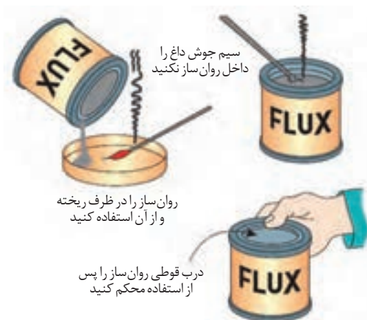
شکل ۲۸- روش استفاده از روان ساز
