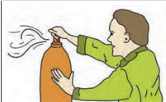
شکل ۱۳- روش تمیز کردن محل اتصال کپسول
