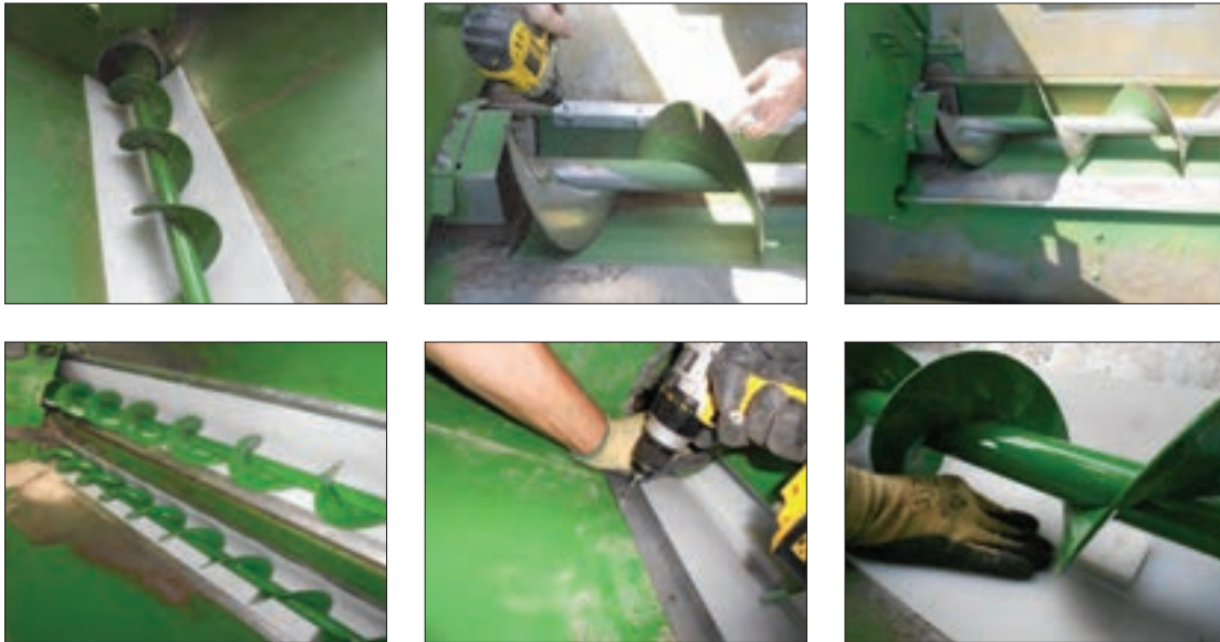
شکل ۳۵- تعمیر محفظه زیرین هلیس مخزن کمباین
