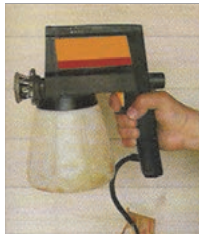
شکل ۶۱- پیستوله بدون کمک هوای فشرده (Airless)
