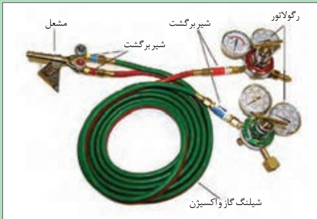
شکل ۱۸- محل نصب سوپاپ‌های یک طرفه (شیر برگشت)
