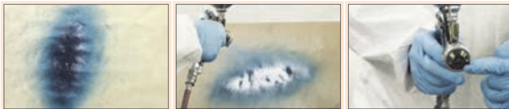
شکل ۶۶- تنظیم جهت پاشش
