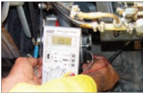
شکل ۳۰- آزمایش اجزای داخلی آلترناتور
