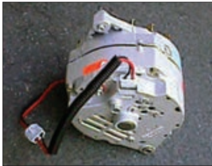
شکل ۱۸- آلترناتور مجهز به آفتامات الکترونیکی
