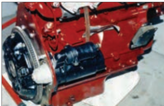
شکل ۳۳- اتصال موتور استارتر به دنده فلاپویل
