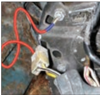
شکل ۲۷- آزمایش مدار لامپ شارژ
