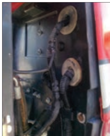
شکل ۳- ثابت کردن کلاف روی بدنه تراکتور
