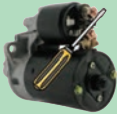
شکل ۴۳- اتصال کوتاه موتور استارت
