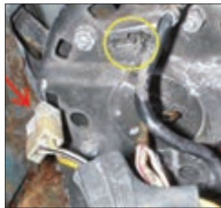
شکل ۲۶- جدا کردن کاتوچویی سیم‌کشی لامپ شارژ
