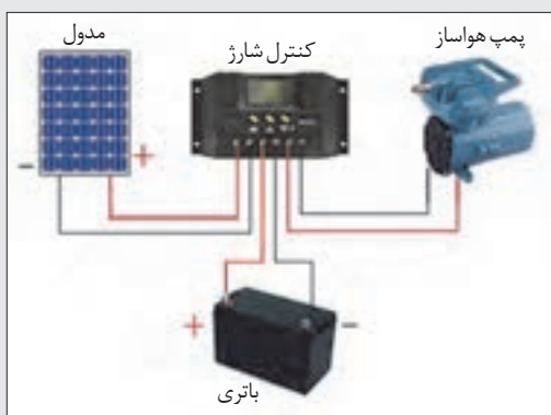
شکل ۴۱- مدار الکتریکی هواساز
