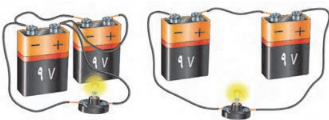
شکل ۱۵- اتصال سری و موازی پیل الکتریکی
