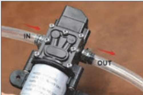
شکل ۳۲- اتصال پمپ و رعایت جهت حرکت سیال
