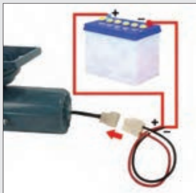
شکل ۴۲- اتصال پمپ با سوکت به باتری
