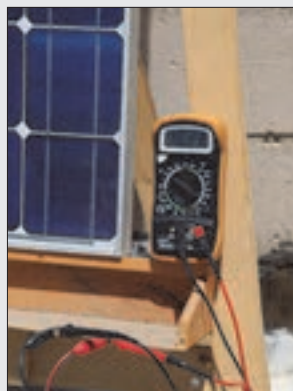
شکل ۲۲- اندازه‌گیری ولتاژ بی‌باری
