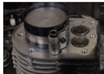
شکل ۳۲- جا زدن پیستون
