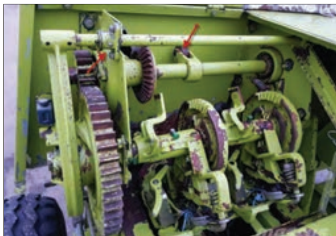
شکل ۷۵- یاتاقان‌ها و نگهدارنده فرمان‌دهنده گره‌زن
