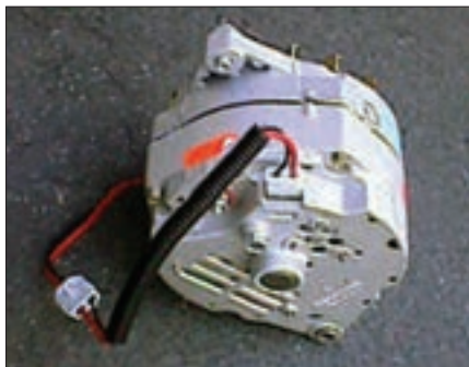
شکل ۱۸- آلترناتور مجهز به آفتامات الکترونیکی
