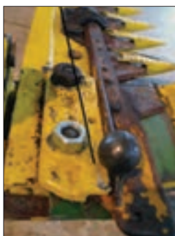
شکل ۶۳- تنظیم لقی سر شانه برش
