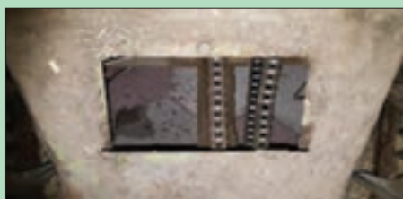
شکل ۲۶- درپوش روغن کاری زنجیر محرک واحد درو
