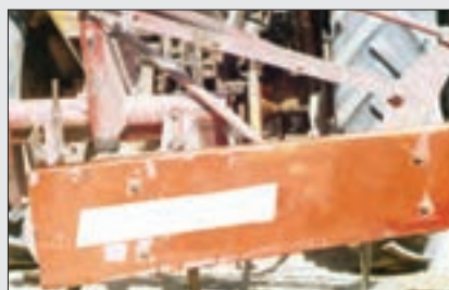
شکل ۷- باز کردن حفاظ تسمه‌ها
