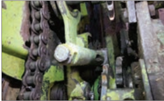
شکل ۴۳- اهرم و پیچ تنظیم تیغه ثابت
