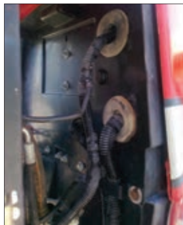
شکل ۳- ثابت کردن کلاف روی بدنه تراکتور
