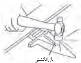
شکل ۶۶- کم کردن فاصله بال با تیغه
