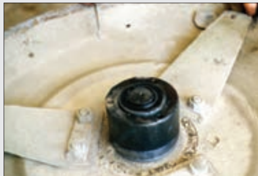
شکل ۴۶- خار فنری استوانه
