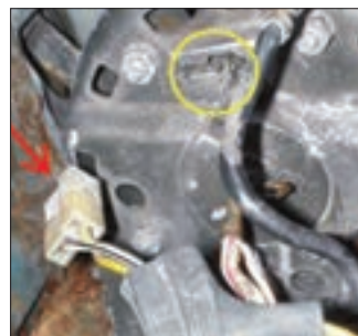
شکل ۲۶- جدا کردن کائوچویی سیم‌کشی لامپ شارژ
