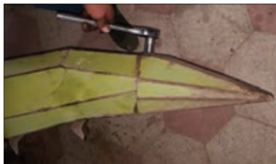
شکل ۲۲- تعویض کلگی دماغه
