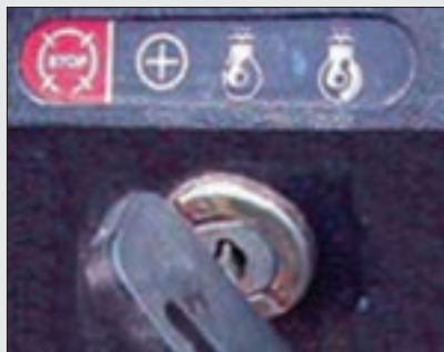
شکل ۹- مراحل سوئیچ تراکتور MF399
