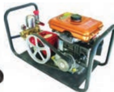
شکل ۱۹- انتقال قدرت در سم‌پاش‌های زنبه‌ای
