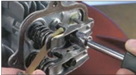
شکل ۳۵- فیلر کردن سوپاپ
