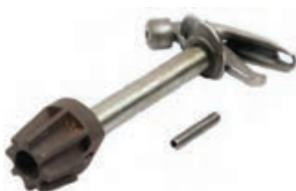
شکل ۳۹- قلاب گره‌زن و چرخ‌دنده آن
