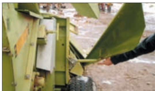
شکل ۲۳- پایه نگهدارنده صفحه جداکننده
