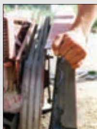
شکل ۸- برداشتن قاب تسمه‌ها
