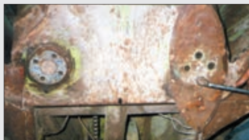
شکل ۳۱- باز کردن تیغه متحرک
