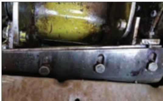
شکل ۴۴- پیچ و شیارهای رگلاژ تیغه متحرک
