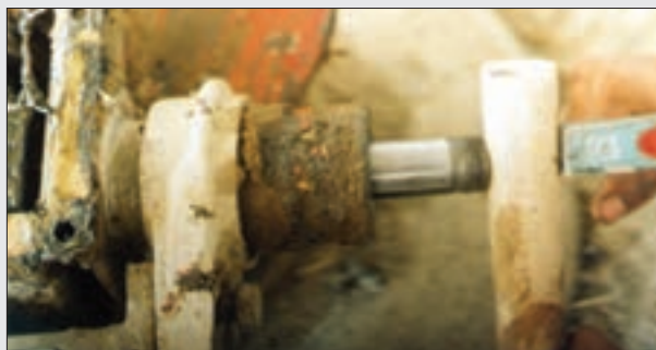
شکل ۲۳- خارج کردن محور ورودی
