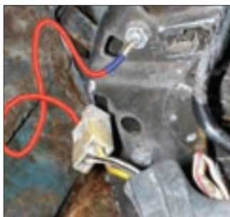
شکل ۲۷- آزمایش مدار لامپ شارژ
