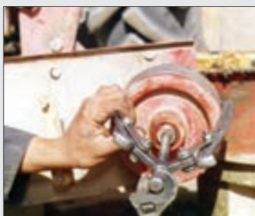
شکل ۱۰- خارج کردن چرخ تسمه
