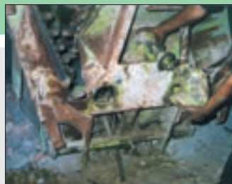
شکل ۲۴- برداشتن جعبه‌دنده دوقلو
