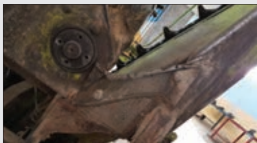
شکل ۳۲- پیچ‌های متصل به تیغه ثابت
