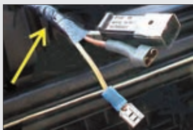
شکل ۲۳- عایق‌بندی اتصالات
