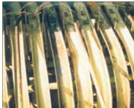
شکل ۶- ساییده شدن انگشتی‌ها به تسمه‌های راهنما
