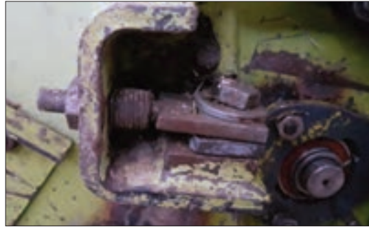
شکل ۴۲- پیچ تنظیم تیغه ثابت
