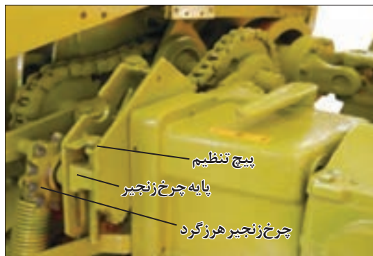
شکل ۷- زنجیر سفت کن با چرخ زنجیر واسطه
