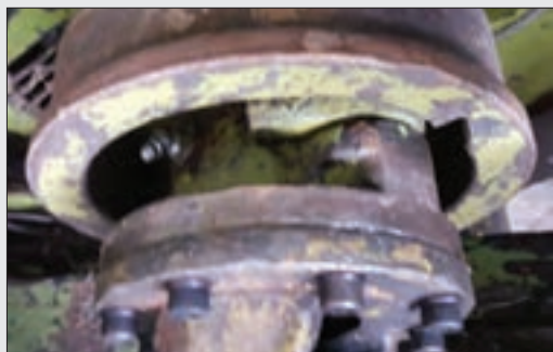
شکل ۴۸- پیچ های اتصال کلاچ به یوک چهارشاخه گاردان
