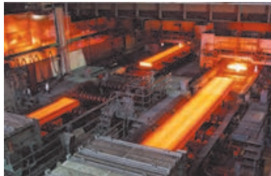
شکل ۳ ▲ نورد گرم ورق فولادی
