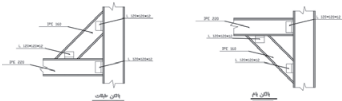
شکل ۴۰ ▲ اتصال تیر کنسول به ستون
