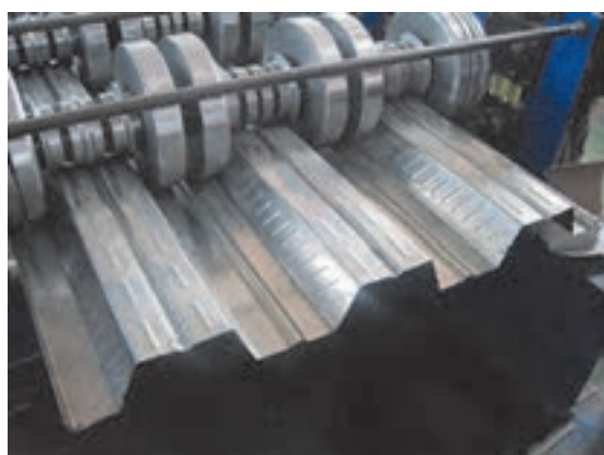
شکل ۳۵ ▲ روش تولید ورق عرشه فولادی
