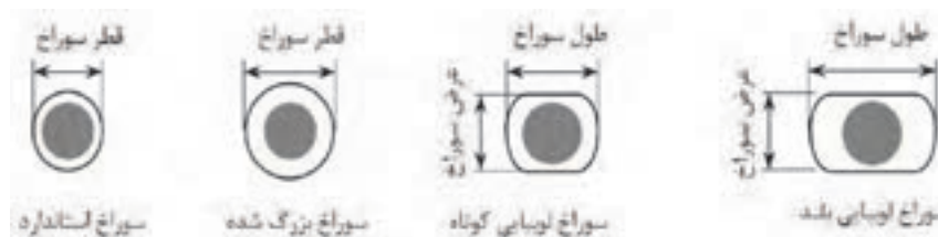
شکل ۹۹ ▲ انواع سوراخ پیچ‌ها در اتصالات پیچی
