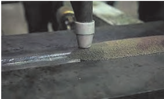
شکل ۷۳ ▲ جوشکاری قوس الکتریکی زیر پودری
