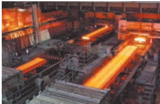
شکل ۳ ▲ نورد گرم ورق فولادی
