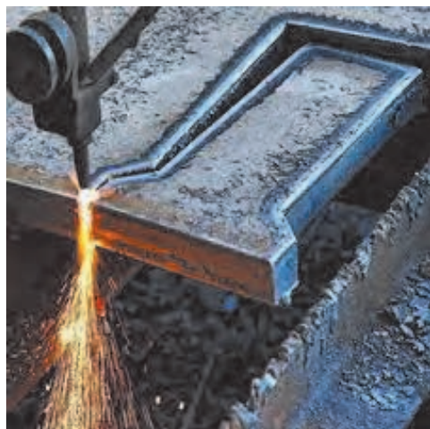
شکل ۴۸ ▲ برش کاری ورق کله‌گای
