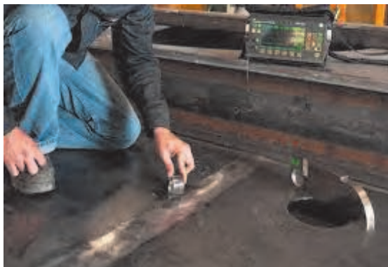
شکل ۹۱ ▲ بازرسی به روش اولتراسونیک
