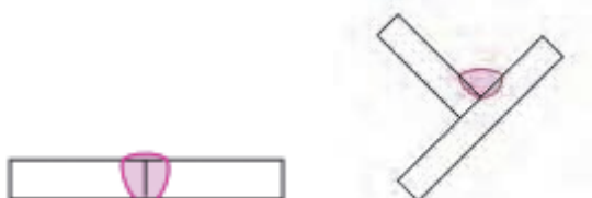
شکل ۷۷ ▲ جوشکاری در وضعیت تخت
