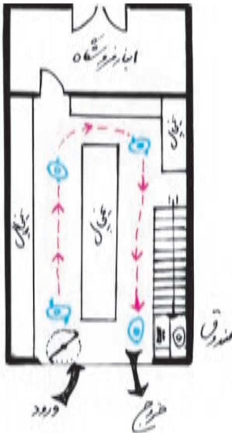
شکل ۲-۶- پلان ساده فروشگاه و در نظر گرفتن مسیری ساده برای ورود، عبور، و خروج مشتریان.
